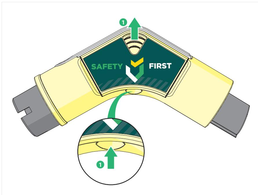
Prima di poter utilizzare il prodotto, è necessario rimuovere la protezione della batteria:
